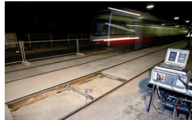
06 | Messungen Rillenschienenummantelung
