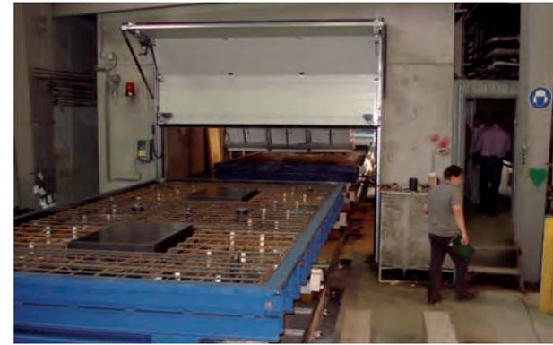
04 | Schalung und Bewehrung vor dem Einbringen des Betons
