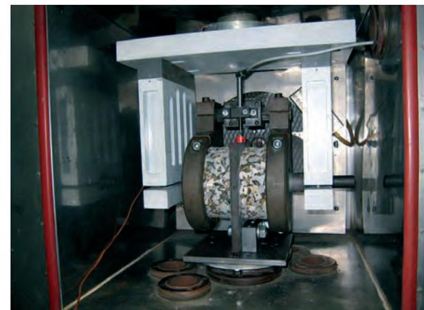
12 | Schubprüfung an Bohrkernen viskoelastischer Baustoffe
