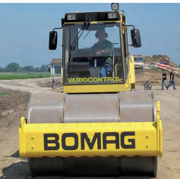
14 | Vario-Control-Walze mit Polygonbandage (innovative Verdichtungstechnologie)
