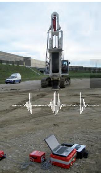
09 | Schwingungsmessungen (links) und Entfernungsabhängigkeit der Erschütterungen infolge Impulsverdichtung (rechts)
