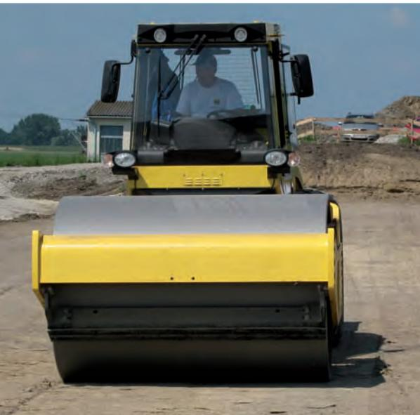
13 | Vibrationswalze mit Glattmantelbandage (konventionelle Verdichtungstechnologie)
