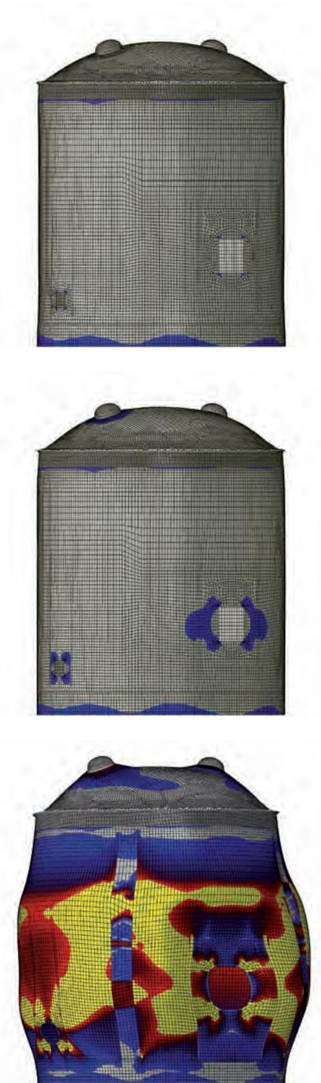
07 | Schädigung durch Rissbildung (dargestellt in unterschiedlichen Farbtönen) und überhöht dargestellte Verformung des Reaktorsicherheitsbehälters (a) unter dem Bemessungswert des Innendruckes  $p$  (oben), (b) unter  $2,0 p$  (Mitte) und (c) kurz vor dem Versagen unter  $2,9 p$  (unten)
